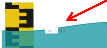
Inquadrando il codice QR con la fotocamera dello smartphone, l'utente è indirizzato direttamente alla maschera della stazione in cui inserire il livello idrico appena letto (in cm) tramite un menù a tendina (senza dover digitare numeri per minimizzare gli errori di battitura).
